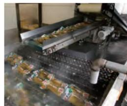
加熱殺菌処理後に冷水で22℃まで冷やし、温風で乾燥処理を行います。加熱殺菌処理を行います。約80℃の熱湯に約20分間通して
