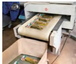
金属探知機により、金属製の異物がないかを検査します。
